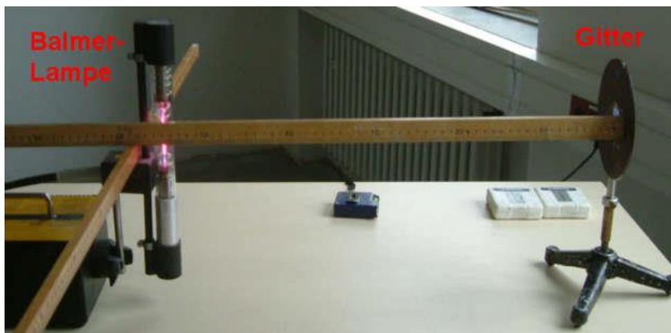
Man beobachtet eine mit Wasserstoffgas gefüllte und durch hohe Spannung zum Leuchten angeregte Röhre (Spektralröhre). Das lila Licht dieser Röhre betrachtet man durch ein Rowland- Gitter (Gitter mit 570 Strichen pro mm) und sieht sowohl links als auch rechts farbige Linien (unten). Dies sind die virtuellen Bilder der Spektralröhre. Mittels Maßstab an der Lampe kann man den Schwinkel bestimmen.
