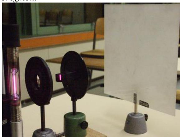
Um das Wasserstoffspektrum zu zeigen, benötigt man einen Spektralapparat. In der einfachsten Form besteht dieser - wie in obiger Abbildung - aus einer Wasserstoff-Entladungslampe, einer Sammellinse, einem Prisma (hier ein Amici-Geradsichtprisma) und einem Schirm. Die elektrische Entladung regt die Wasserstoffatome zur Aussendung eines purpur-violetten Lichts an:
